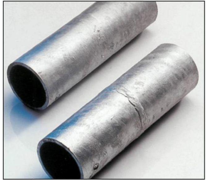
Fotos viser overfladerne på 2 prøver efter varmforzinkning. På den ene prøve er der ingen overtykkelse af zink på svejsesømmen, på den anden prøve er overtykkelsen tydelig. Herunder ses nærbilleder af svejsesømmene.
