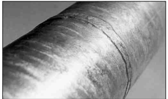
Fotos viser overfladerne på 2 prøver efter varmforzinkning. På den ene prøve er der ingen overtykkelse af zink på svejsesømmen, på den anden prøve er overtykkelsen tydelig. Herunder ses nærbilleder af svejsesømmene.
